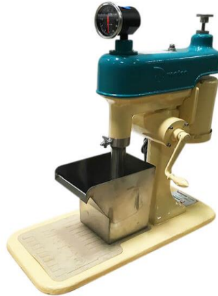
Figura 11. Célula de flutuação Denver - Imagem de catálogo (fonte: https://www.911metallurgist.com/equipment/denver-d12-laboratory-flotation-machine/ ).
